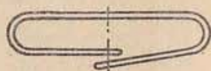
Figura 3.4. Dipol confecționat în dispozitivul de încovoiere. Capetele care se suprapun se taie corespunzător după încovoiere.
