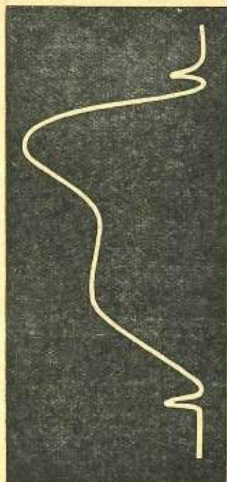
Fig. 4.4. Curba spectrală în cazul stingerii fasciculului electronic în timpul cursei de întoarcere a oglinzii de explorare a spectrului.
