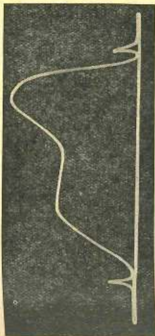
Fig. 4.5. Curba spectrală în cazul obturării fluxului luminos studiat în timpul cursei de întoarcere a oglinzii de explorare a spectrului.
