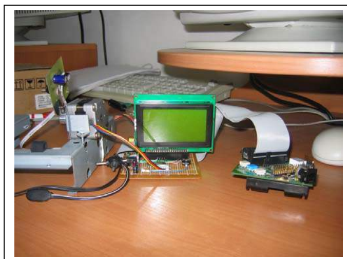
Figura 4. 48: Motorul pas cu pas și senzorul (stânga) și o fotografie a sistemului de test (dreapta)
