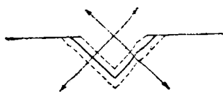
Fig. 8. Sistemul de imprimare stereo 45/45. Pe fiecare perete al rilei este tăiat un semnal.
