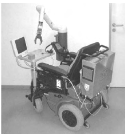
Fig. 1.4 Robot cu arhitectură hibridă, pentru asistarea persoanelor handicapate
