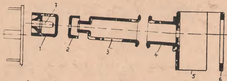
Fig. 8.2 Elementele componente ale tubului de electroni al unui tub „delta”
