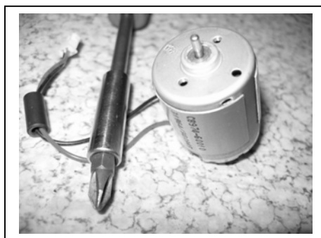
Figura 5.6: Motor de curent continuu
