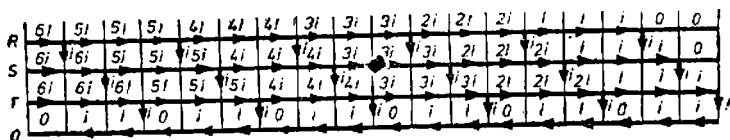
Fig. 6.3. Varianta a II-a de repartizare a receptoarelor pe cele trei faze (distribuție RST).
