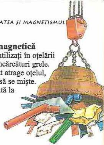
Macara electromagnetică folosită la mutarea metalului vechi dintr-un loc în altul
