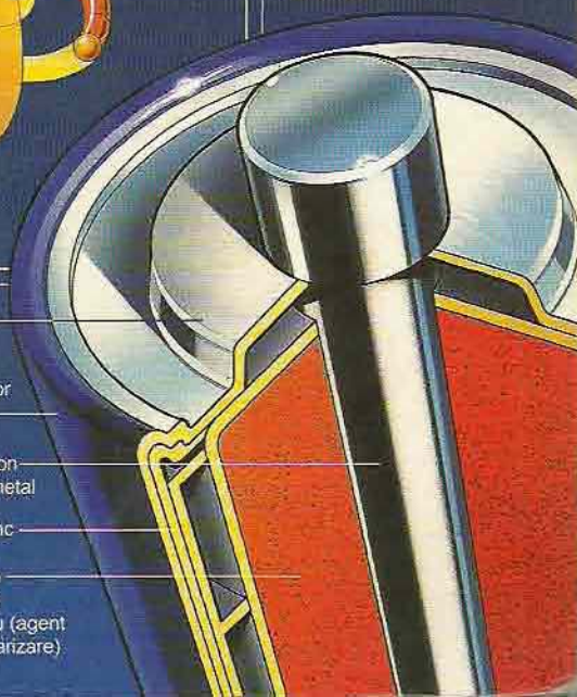
Secțiunea unei baterii de zinc-carbon
