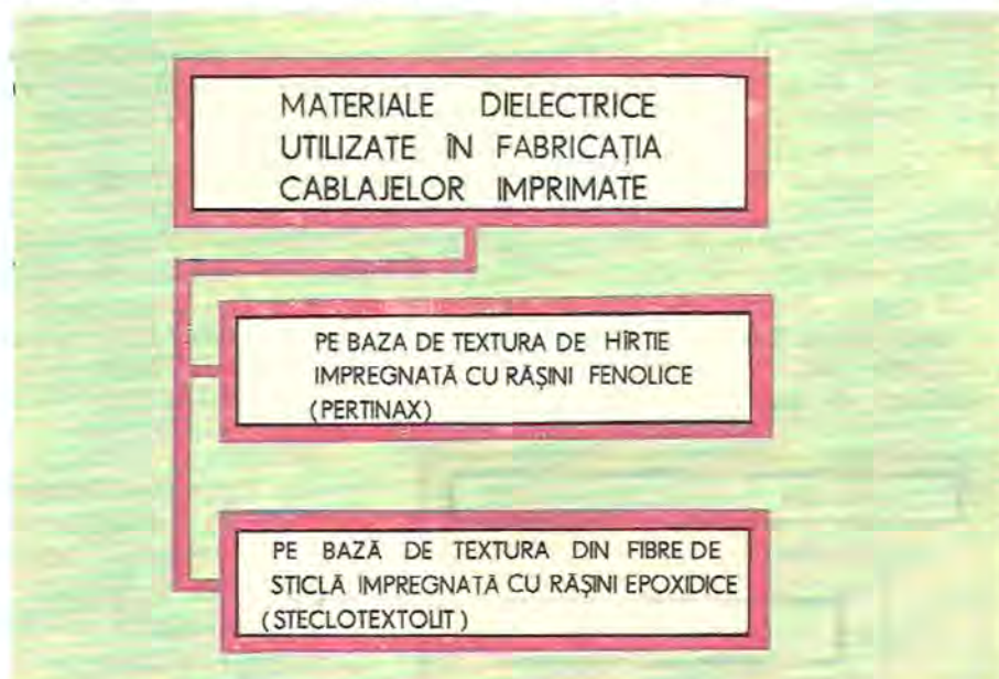
Fig. 4.1. Principalele materiale electroizolante utilizate ca suport al circuitelor imprimate.
