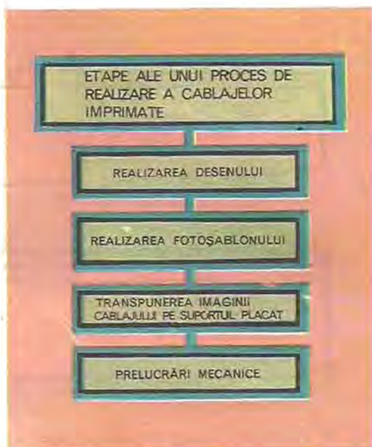
Fig. 4.4. Etapele de bază ale unui proces tehnologic de realizare a cablajelor imprimate.
