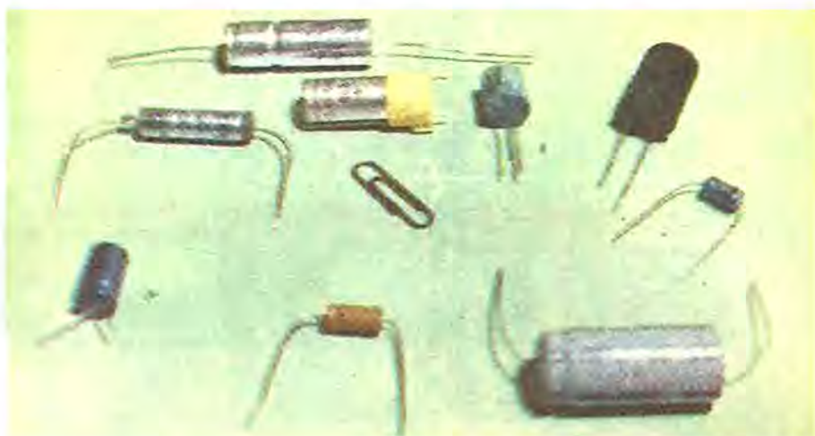
Fig. 2.28. Tipuri de condensatoare electrolitice cu aluminiu.
