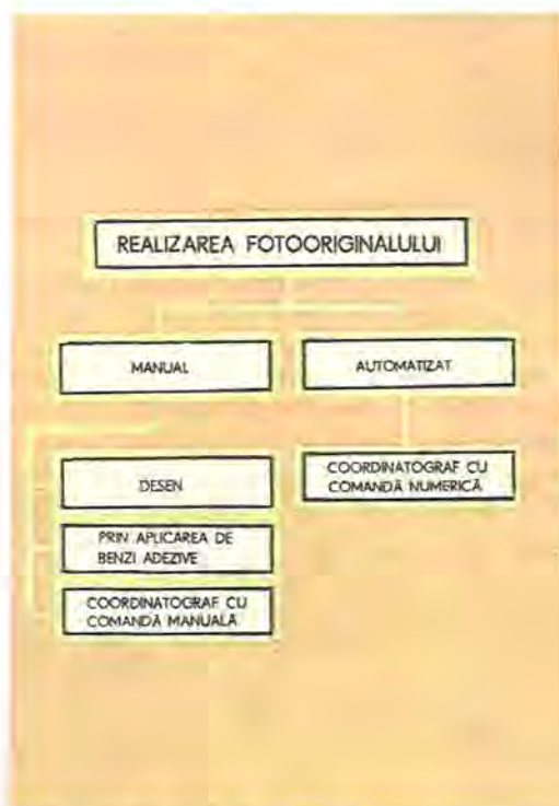
Fig. 4.11. Moduri de realizare a fotooriginalului.
