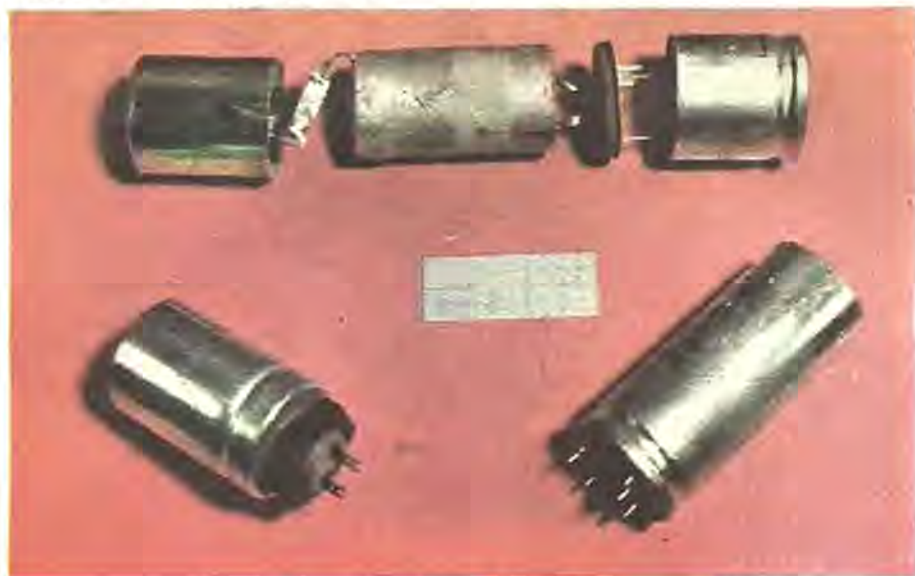
Fig. 2.27. Condensator electrolitic cu aluminiu în carcasă de aluminiu.
