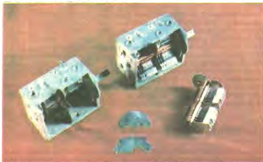
Fig. 2.31. Condensator variabil cu aer asamblat și părțile lui componente: rotor, stator, lamelă stator, lamelă rotor.
