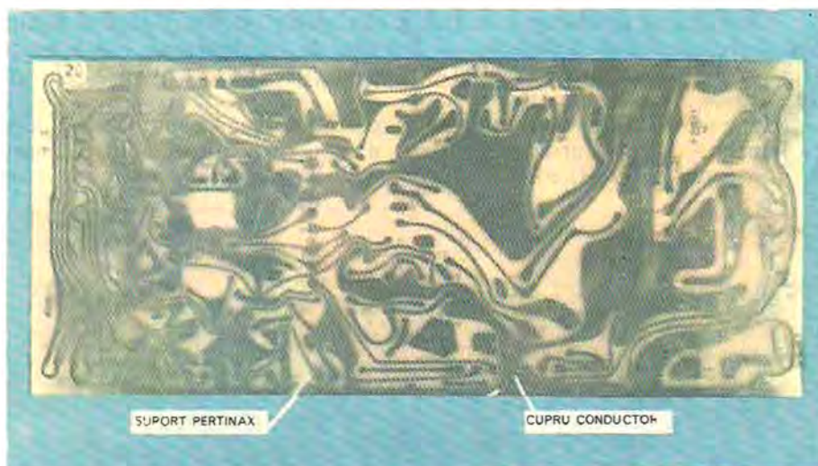
Fig. 4.20: Cablaj imprimat, imediat după corodare.
