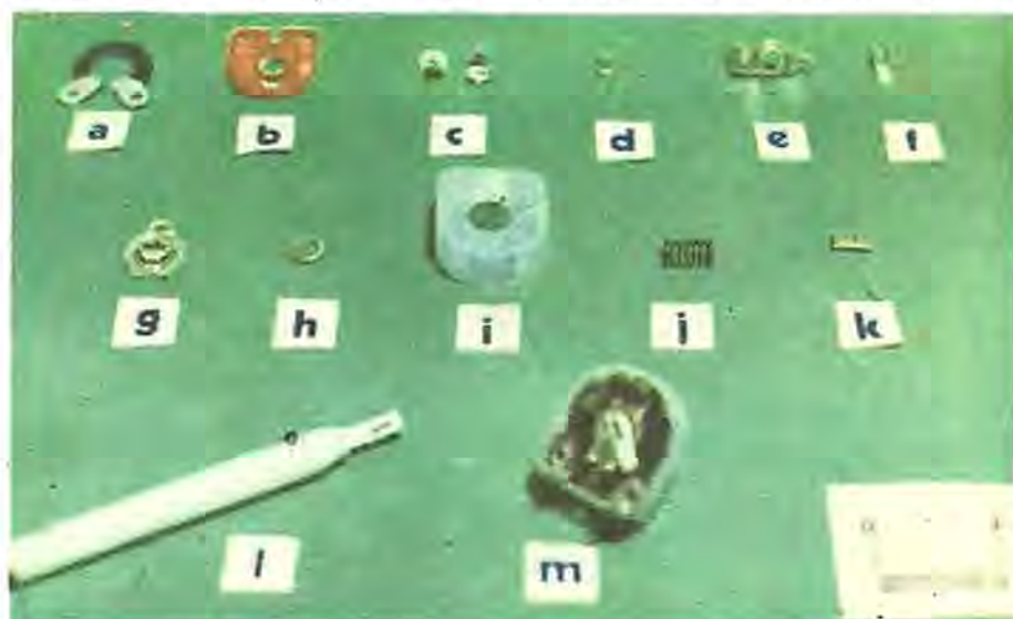
Fig. 1.29. Fazele tehnologice de fabricare a potențiometrelor peliculare: a — element rezistiv; b — suport din pertinax; c — cota stîngă și dreaptă; d — capsă; e — cota centrală; f — opritor; g — cursor; h — șaibă metalică; i — capac de plastic; j — resort; k — pană; l — ax; m — produs final.
