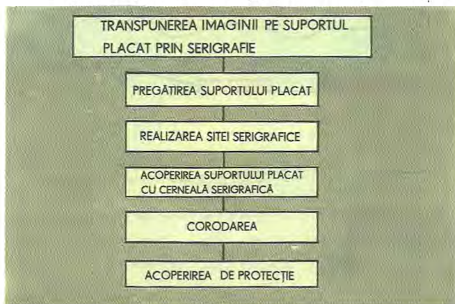
Fig. 4.9. Transpunerea imaginii pe semifabricatul placat, prin serigrafie.
