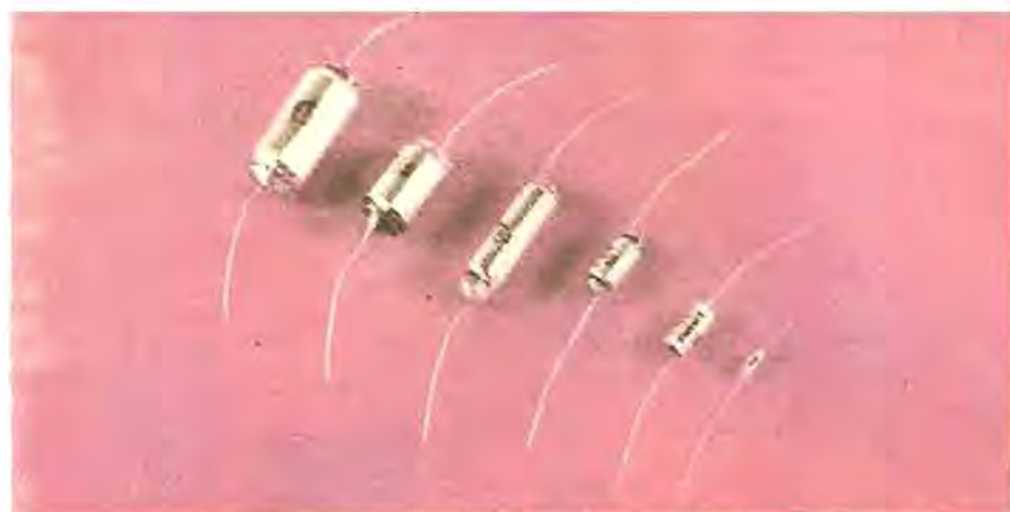
Fig. 2.21. Condensatoare cu polistiren (știroflex).
