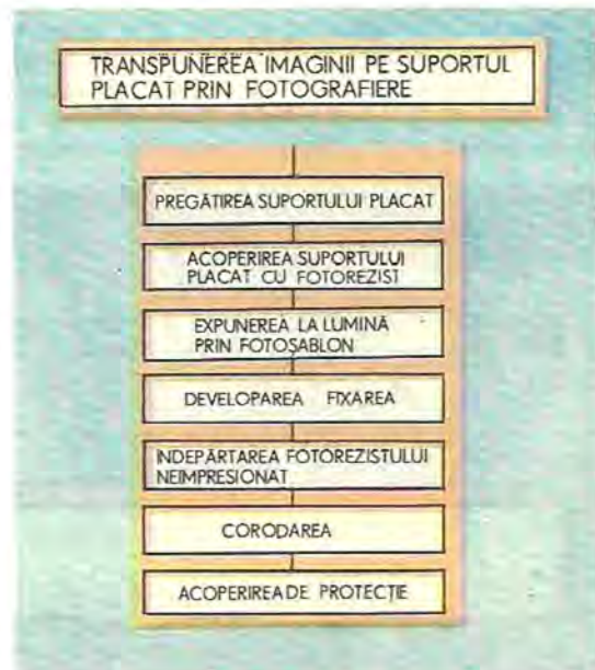
Fig. 4.5. Transpunerea imaginii pe semifabricatul placat, prin fotografiere.
