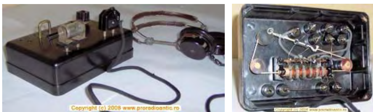
Fig.II.2.2 Radioreceptor cu galenă și căști , realizat cu seturi din URSS, vedere față și șasiu, schemă și soluție tehnică primitivă nemai utilizată în vest în industria anilor 1950
