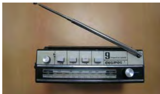
Radioreceptor Gloria S – se remarcă echiparea radioreceptorului pentru recepția în gamele de UL,UM,US1,US2,UUS
