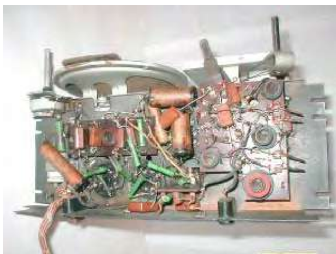
Fig II.2.7. Montaj filar la radioreceptorul Pionier S 503 A. Se remarcă traseul aerian al conexiunilor și al componentelor pasive.
