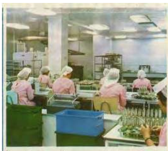
Fig. III.3.3. Asamblarea tunului electronic
