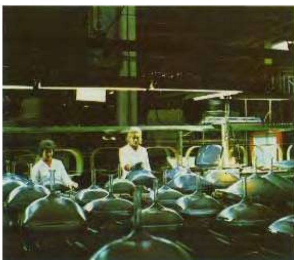
Fig. III.3.4. Standul de verificare a tuburilor cinescop
