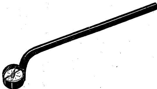
Fig. 70. Busolă pentru identificarea scurtcircuitelor dintre plăcile elementelor staționare.
