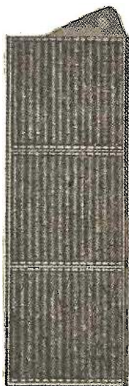
Fig. 86. Placă de acumulator alcalin Ni-Fe, în tuburi.
