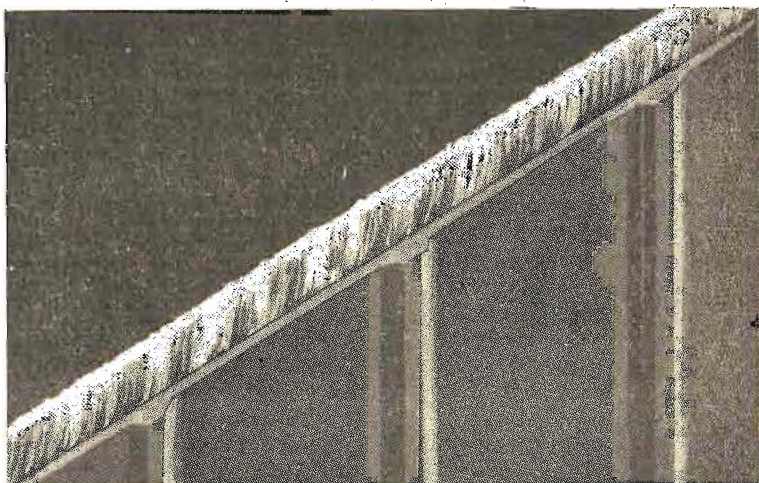
Fig. 11. Separatoare din vată de sticlă și policlorură de vinil microporos.
