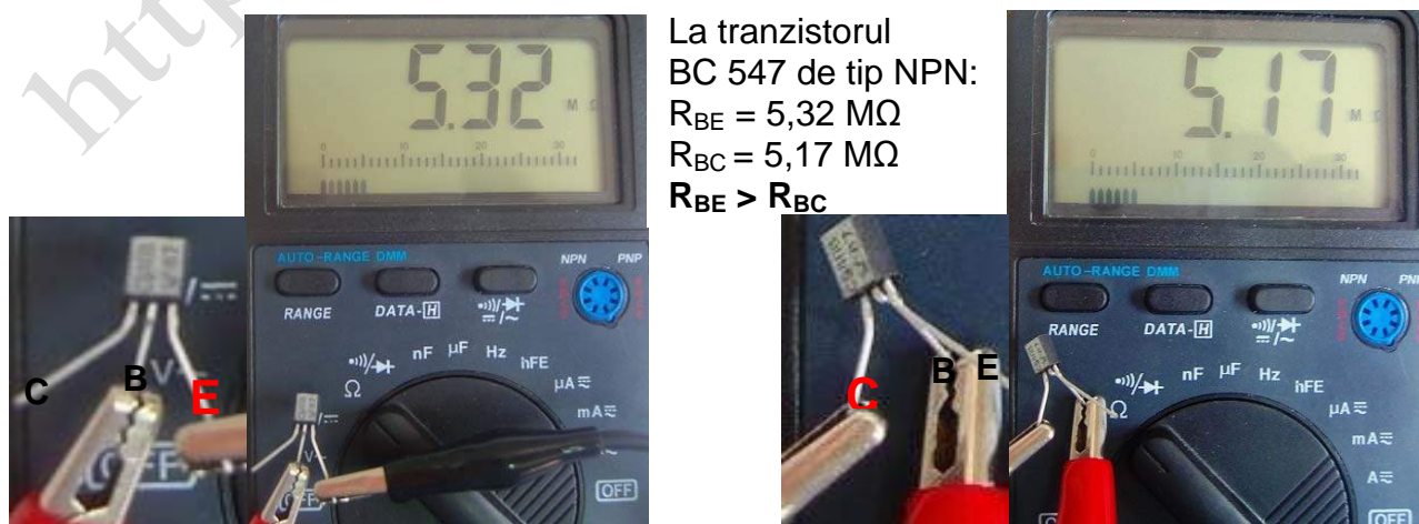
Figura 5.1.12 Identificarea EMITORULUI și COLECTORULUI
