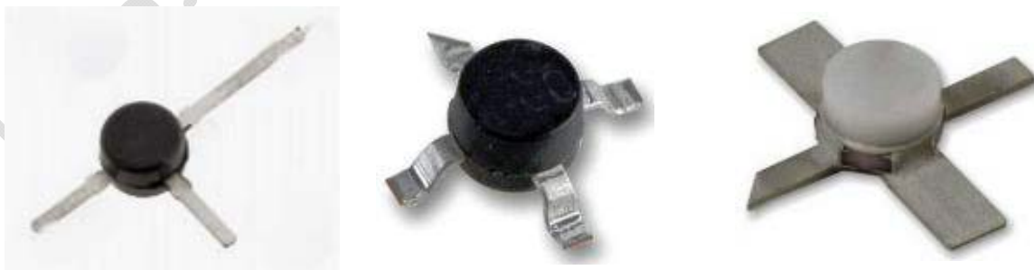
Figura 5.1.5 Capsule de tranzistoare de radio-frecvență
