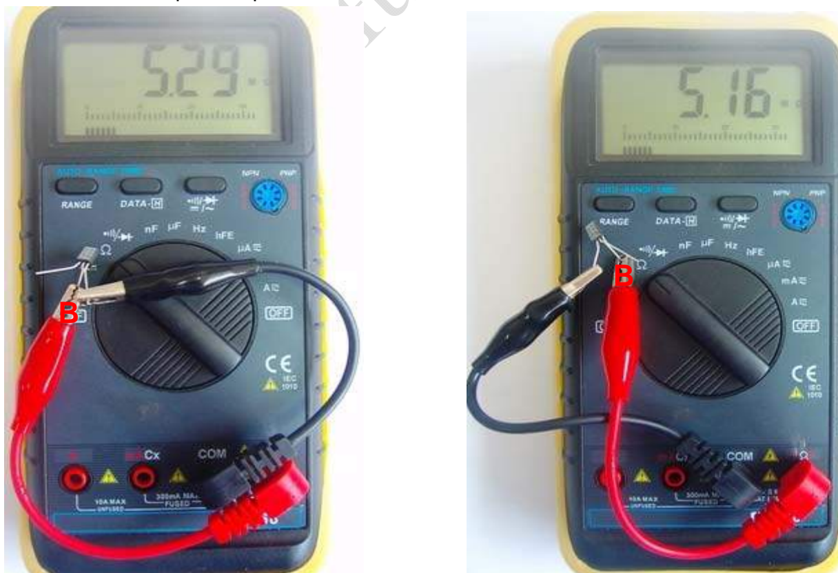
Figura 5.1.10 Identificarea BAZEI tranzistorului bipolar
