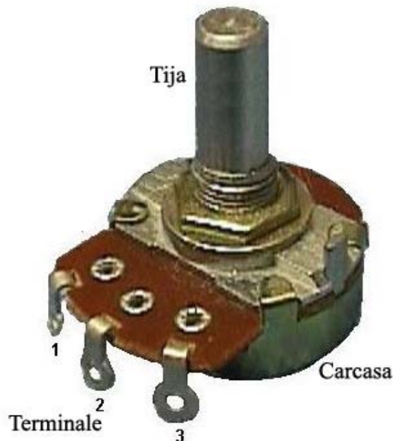
Figura 11. Elementele constructive ale unui potentiometru
