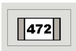
Figura 7. Rezistor SMD, 4.7k \Omega
