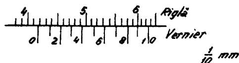
Fig. 2.11. Vernier cu diviziune \frac{1}{10} mm.
