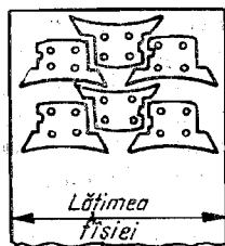
Fig. 8.27. Planul de ștanțare a tolelor pentru pol.
