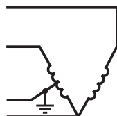
(h) Trifazat triunghi deschis; patru conductoare; mijlocul unei faze legat la pământ
