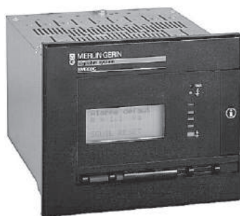
Fig. F16: Dispozitiv pentru realizarea controlului izolației între fază și pământ, obligatoriu în sistemele IT.
