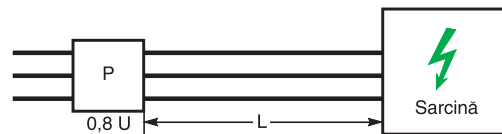
Fig G46: Definiția lui L pentru un circuit trifazat cu 3 conductoare.
