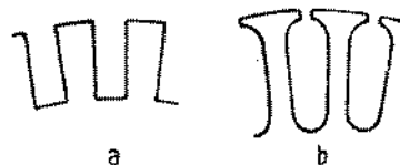
Fig. 2.2. Formarea creștăturilor indusului: a — creștături deschise; b — creștături semiînchise.
