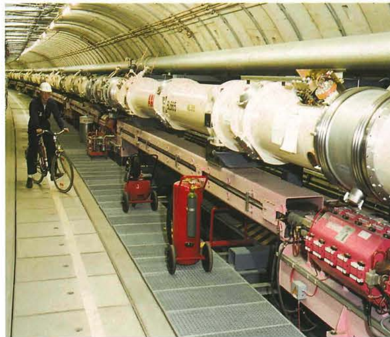
Instalația de accelerare electroni-protoni în interiorul tunelului inelar HERA.
