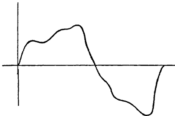
Fig. 50. — Orice variație periodică poate fi descompusă într-o serie de sinusoidale componente.
