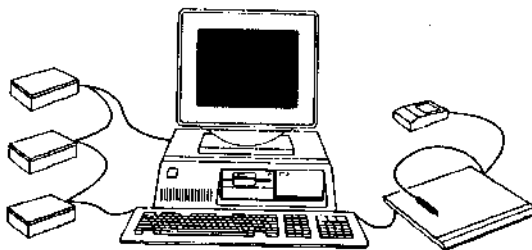
Figura 1.27. Magistrala ACCESS.bus – o alternativa cost/performanta interfetei RS-232C
