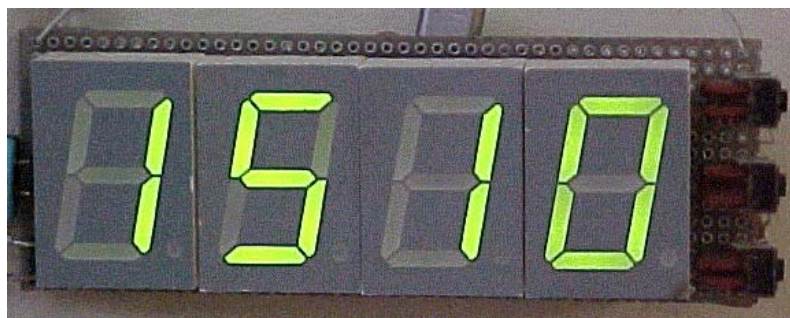
Fig.3-15 Ceas electronic montat pe placă prototip
