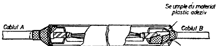
Fig. 89. Poziția finală a manșonului tubular.
