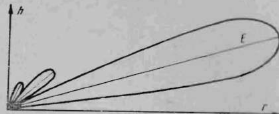
Fig. 9. Caracteristica de directivitate cu mai multe loburi obținută ca rezultat al interferenței dintre unda directă și cea reflectată.
