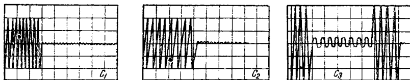
Fig. 9.33. Trenurile de undă furnizate de generatorul de semnale de test : C_1 – cu durata de 128 perioade; C_2 – cu durată de 8 perioade; C_3 – cu durată de 4 perioade alternate cu 8 perioade.
