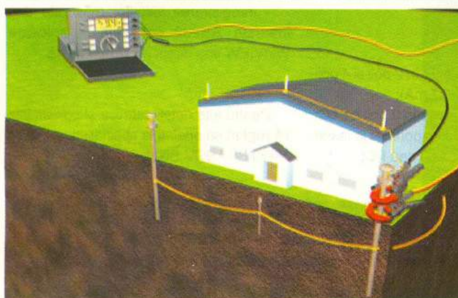
Fig. 28 Măsurarea rezistenței prizei de pământ la clădiri cu paratrâznet (cu clești ampermetrice)
