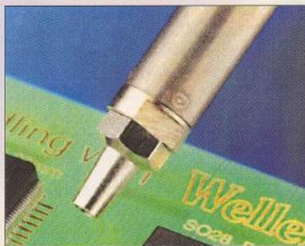
Această mică cantitate de material de lipit este deja suficientă pentru lipirea capsulelor PLCC sau QFP.
