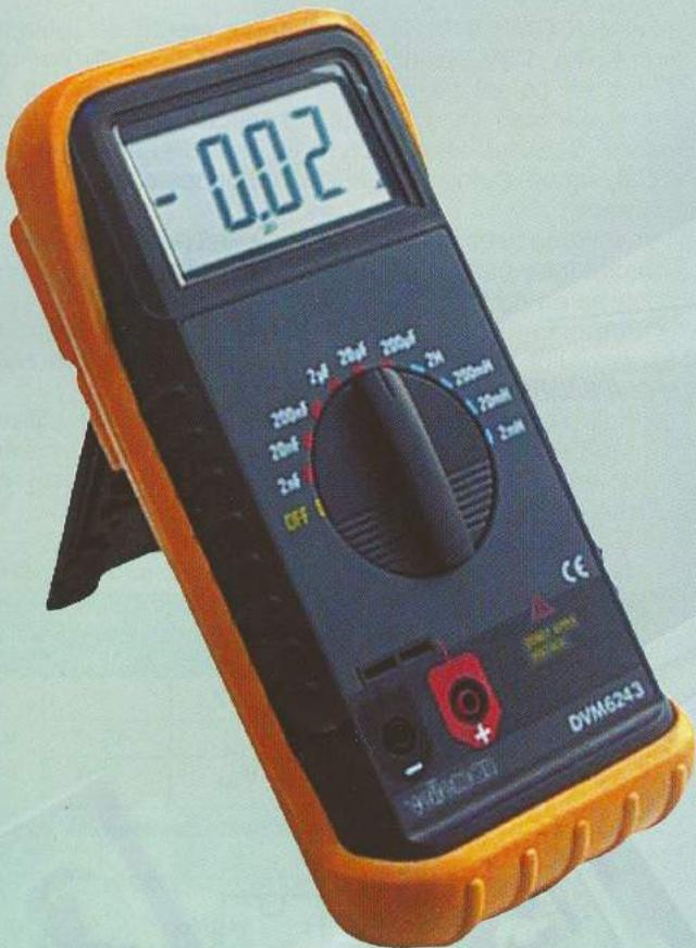
Instrumentul prezentat este un LC-metru digital care măsoară și afișează direct inductanțe și capacitați pe un display LCD cu 3 ½ digiti. Are șase domenii pentru măsurarea capacitații (între 1pF și 200μF) și cinci domenii pentru măsurarea inductanței (între 1μH și 2H). Ca o particularitate, pe display se afișează, în afară de unitatea de măsură, sub punctul zecimal, subgama pe care se află comutatorul rotativ de selecție.
