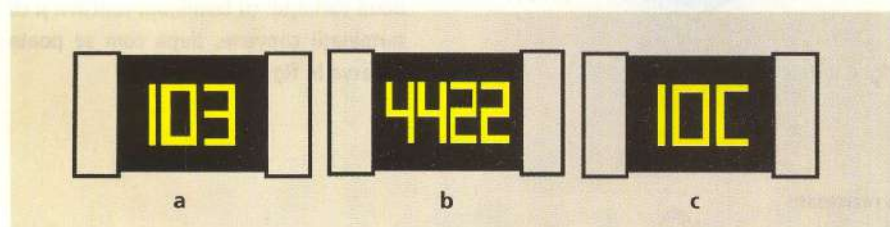
Fig. 4 Exemplu de marcarea rezistoarelor "chip" cu trei digiți (a), cu patru digiți (b), cu trei digiți conform EIA-96 (c)
