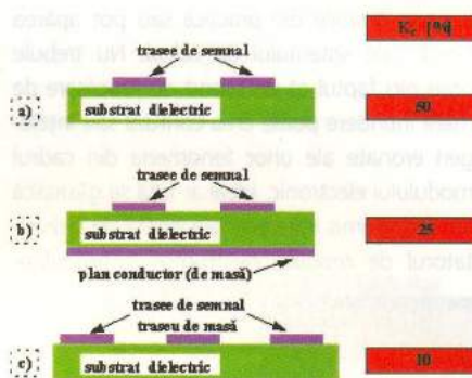
Fig. 3 Comparație între diafonia unor geometrii de interconectare uzuale (s-a considerat că spațierea dintre trasee este egală cu lățimea traseelor)
