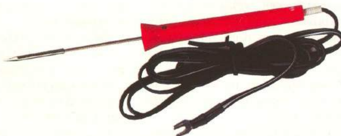
Ciocan de lipit de mică putere, 8W, alimentat la 12Vcc, utilizat în operații de service cu componente SMD (oferit de Conex Electronic de la Donau-Elektronik, Germania)
