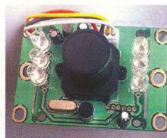
Fig. 3 Minicameră video PCB B/W cu LED-uri IR pentru vedere pe timp de noapte
