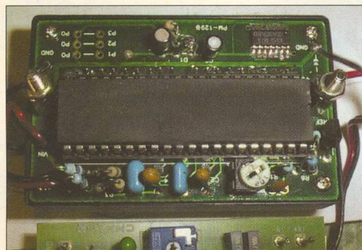
Detaliu amplasare componente panelmetru PM129-B
