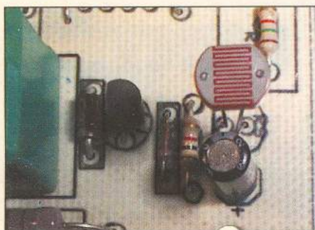
Detaliu poziționare fotorezistor ↑
