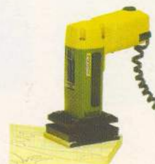
Mașină șlefuit OZI220/E Cod 28520 • 5 000...15 000oscilații/min • Alimentare la 220V ca • Lungime 230mm
