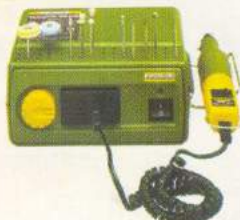
Mașină de găurit FBS12E Cod 28462 • 3 000...15 000rot/min, ø 0,5...3,2 • Alimentare la 12...18V cc • Greutate 450g
