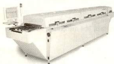
Fig. 1 Cuptor SMT cu bandă transportoare
