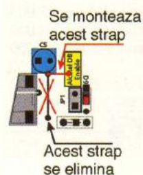
Fig. 4 Operații efectuate pe cablaj pentru utilizarea lui MAX3232
