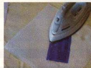
Foto 4 Transferul desenului de pe folie pe laminat
