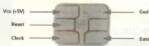
Fig. 1 Pinii la o cartelă telefonică (Smart Card)
