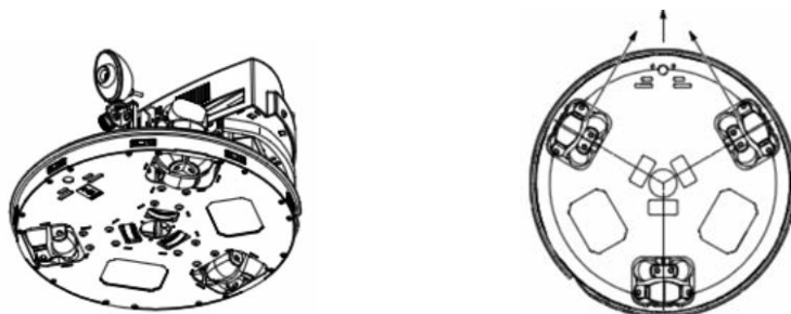
Fig. 10.7 Dispunerea simetrică a roților
