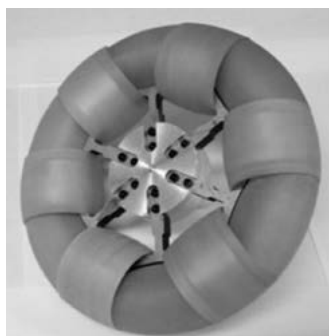
Fig. 10.4 Roata universală cu role alternante
