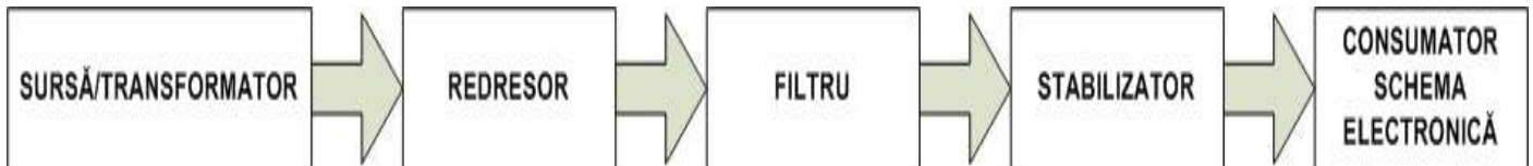
Fig.1.3 Prezentarea stabilizatorului de tensiune continuă în blocul sursei de alimentare
