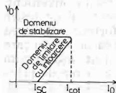
Fig. 3.9. Caracteristica de ieșire cu reducerea automată a curentului de scurtcircuit (limitare prin întoarcere a curentului de ieșire).
