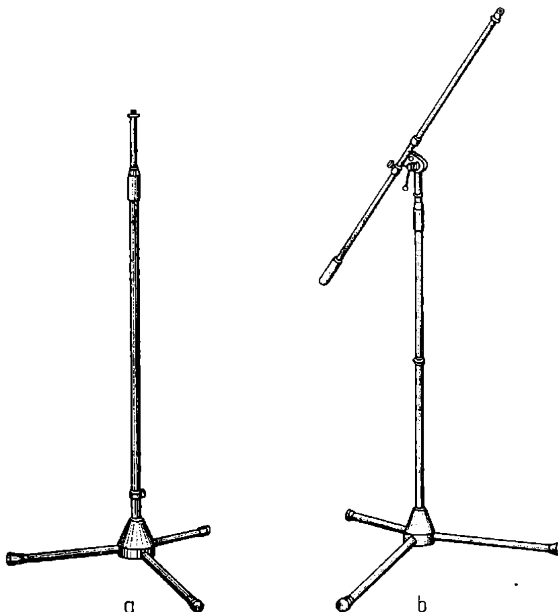
Figura 28 — a) Suport telescopic simplu pentru microfon; b) Suport telescopic, cumpănă reglabilă, pentru microfon.
